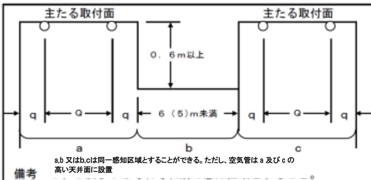
《主たる取付面より低い段違いが中央にあり、その幅が、主要構造部を耐火構造とした防火対象物で6 m（5 m）以上の場合の例》
