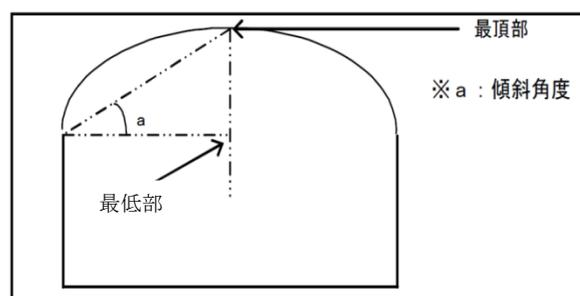
（イ） 傾斜天井等に感知器を設ける場合に、傾斜角度が3/10以上の場合は、頂部が密となるように設け、傾斜角度が3/10未満の場合は、平面天井とみなして設けることができる。
