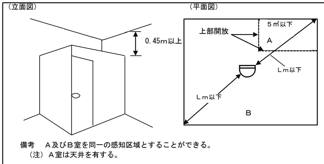
(9) 煙感知器（光電式分離型感知器を除く。以下この(9)において同じ。）の設置は、規則第23条第4項第7号の規定によるほか、次によること。
