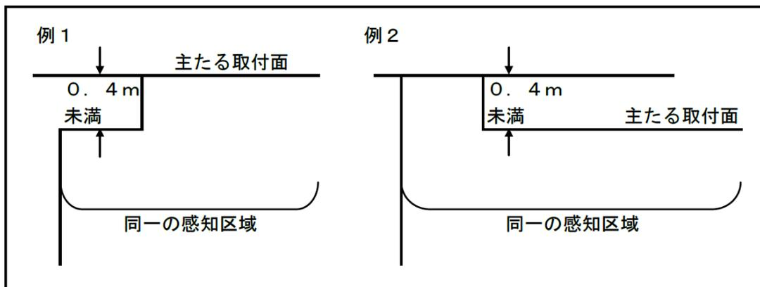
b 段違い天井で段違いが0.4 m以上の場合、段違いを含む居室等の幅が6 m未満の場合は、段違いの形状にかかわらず、当該居室等を同一の感知区域とすることができる。この場合において、感知器は当該居室等の面積に必要な感知器の個数を主たる取付面（同一の感知区域内で、取付面の高さが異なる部分が存する場合は、その取付面の高さに**応じた**面積のうち、最も広い部分の取付面をいう。以下この第1において同じ。）に設けること。ただし、段違いの高い部分の幅が1.5 m以上である場合は、高い天井面に設けること。
