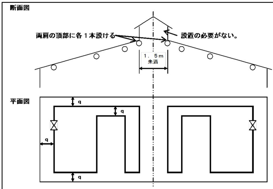
b 越屋根の両肩の間隔が1.5m以上の場合、越屋根の合掌部分を一の感知区域とし、両肩の部分にそれぞれ1本以上の空気管を設け、その他の部分は、傾斜角度が3/10以上の場合には、前(カ)に規定する傾斜天井の例により設けること。
