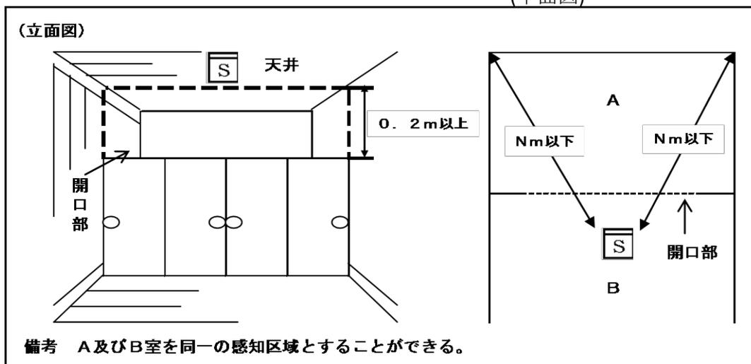
(10) 差動式分布型感知器(以下この第1において「空気管」という。)の設置は、規則第23条第4項第4号の規定によるほか、次によること。
