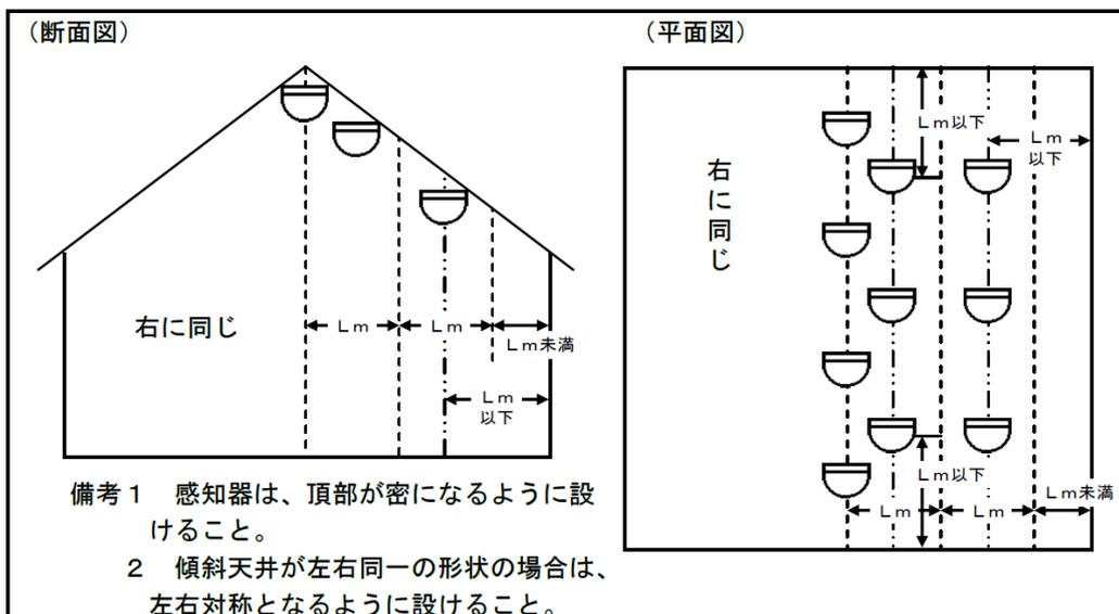
《最頂部から壁面までの水平距離がLm以下となる場合の例》
