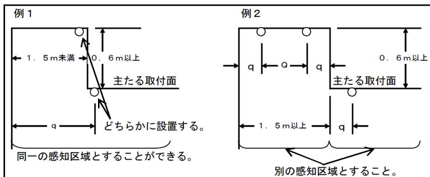
c 主たる取付面より低い段違いが中央にあり、その幅が、主要構造部を耐火構造とした防火対象物にあつては6m(5m)(( )内については主要構造部を耐火構造とした防火対象物以外の場合を示す。以下この(9)において同じ。)m未満の場合は、同一の感知区域とすることができる。ただし、その幅が6m以上となる場合はそれぞれ別の感知区域とすること。
