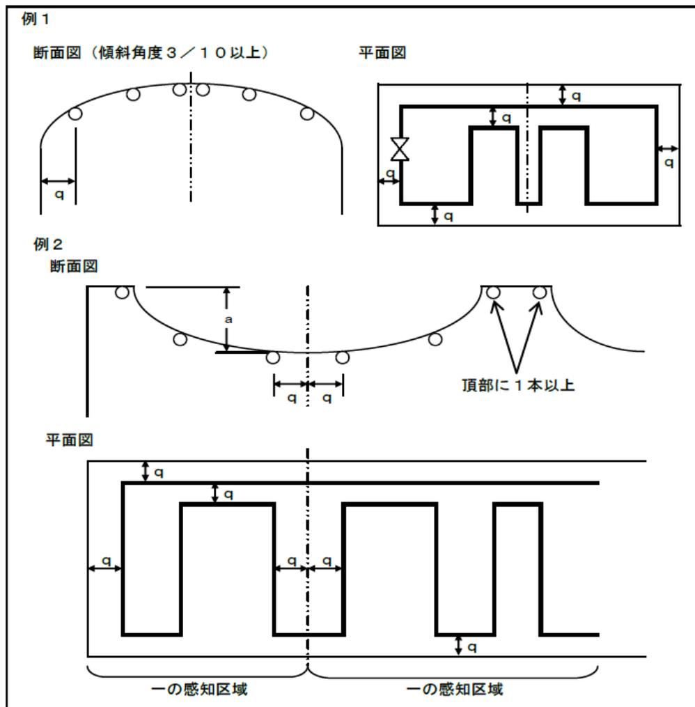
c 前 a において、ノコギリ型天井の頂部に設けた空気が、直射日光等により非火災報を発するおそれのある場合には頂部から下方 1.5 m 以下の範囲内に設けることができる。
