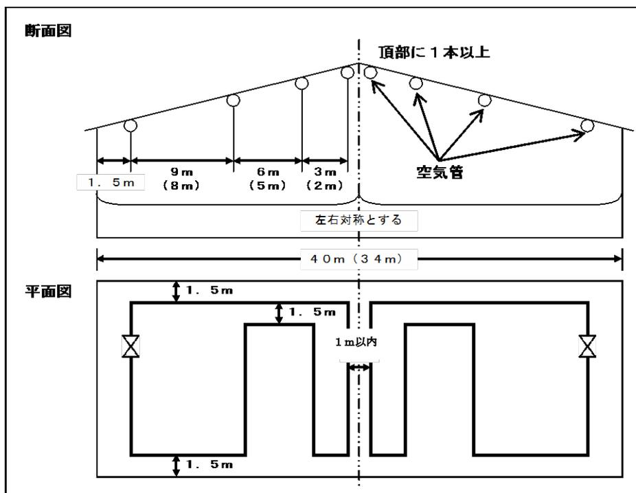
《傾斜天井頂部の空気管の設置例》
