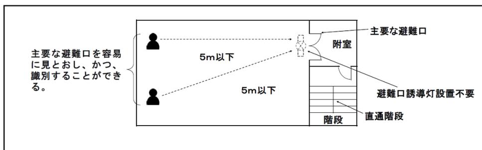
カ 避難階以外の階で、かつ地階又は無窓階である階における居室の各部分から規則第28条の3第3項第1号口の避難口を容易に見とおし、識別することができ、当該避難口に至る歩行距離が概ね5mを超え10m以下である当該避難口で高輝度蓄光式誘導標識の設置及び当該誘導標識を識別できるよう建築基準法施行令第126条の4に規定する非常用照明装置が設けられているもの。
