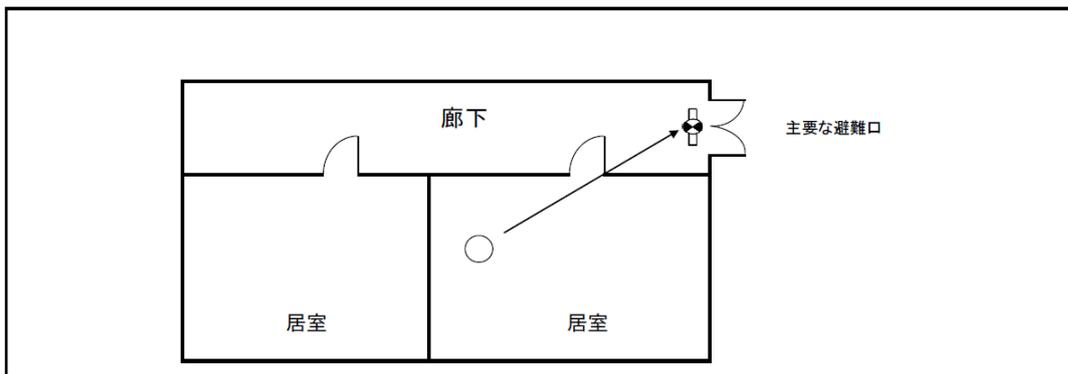
(5) 規則第28条の2第1項第1号、第2項第1号及び第3項第1号に定める階段又は傾斜路以外の部分における誘導灯及び誘導標識の設置免除に係る例は次図のとおりであること。
